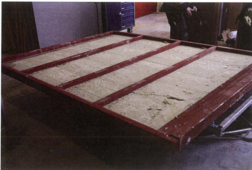
Bild 11 – Trällsskivorna 50 mm bortplockade. Stenullsskivorna 50 mm kan ses.
