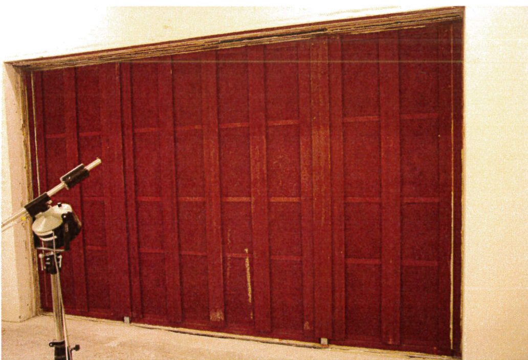
Bild 6 – Skärmens trafikside. Täckbrädor för de två stolparna kan ses. De vertikala brädorna 22x145 sitter på c/c 450 mm.
