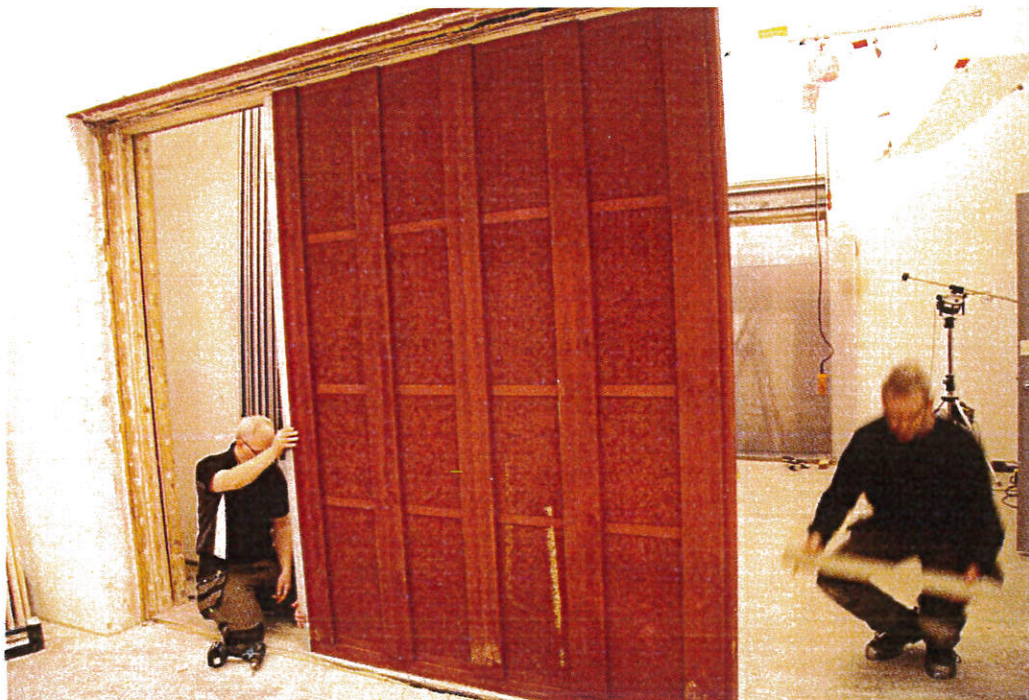
Bild 2 – Provobjektet sett från sidan med trällsskivor. Bild från ljudisoleringsmätning.
