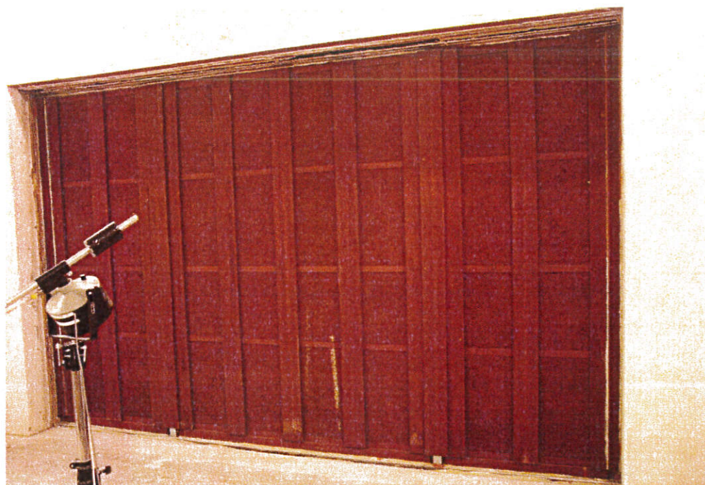
Bild 6 – Skärmens trafiksidan. Täckbrädor för de två stolparna kan ses. De vertikala brädorna 22x145 sitter på c/c 450 mm. Bild från ljudisoleringsmätning.
